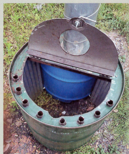
ストーブ内部にはトタン板とカットしたドラム缶で仕切り板を固定。ロケットストーブのように底部部分から煙突に向かって燃え上がる構造に
