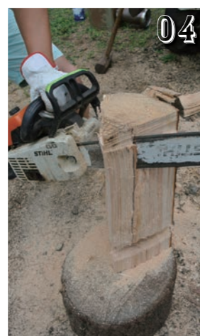
横溝を彫った材の芯部を切り欠く
