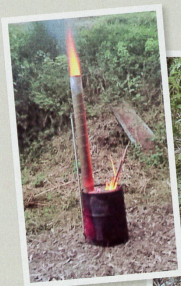
実はストーブの底板は抜いた状態。燃やした灰をすぐに土にまけるようにと工夫されている
