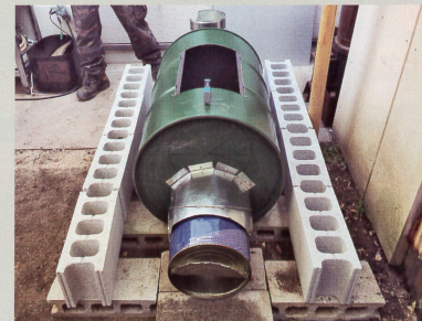
ドラム缶にペール缶の焚き口をつけた炭焼き窯。ドラム缶内部に炭にしたい素材を入れて、ペール缶で火を焚く仕組み
